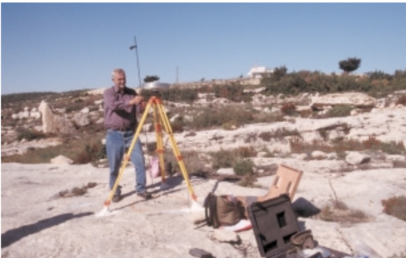
GPS différentiel en action en Syrie (photo E. Barrier)
