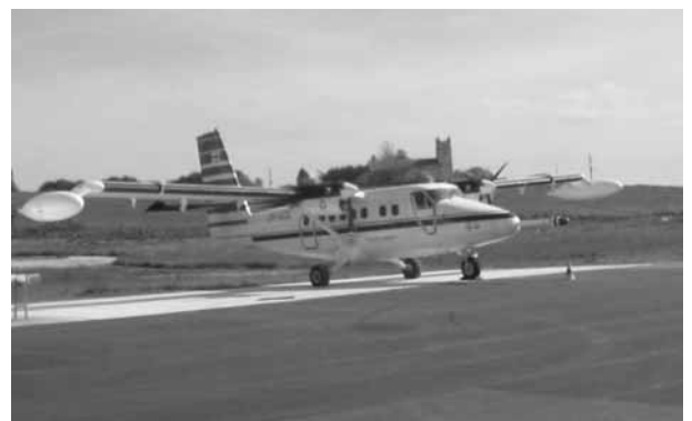
Photo 4. Un avion Twin-Otter équipé pour effectuer des relevés géophysiques. Les instruments à bord comprennent un magnétomètre, un spectromètre radiométrique et des appareils électromagnétiques. Cet avion est sous le contrôle du consortium du Joint Airborne-geoscience Capability (JAC), qui comprend le Service géologique de Finlande (GTK) et le British Geological Survey (BGS).
