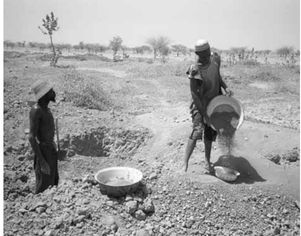
Photo 5. Mineurs d'or locaux utilisant le vent pour séparer l'or du stérile (cliché Noël White).
