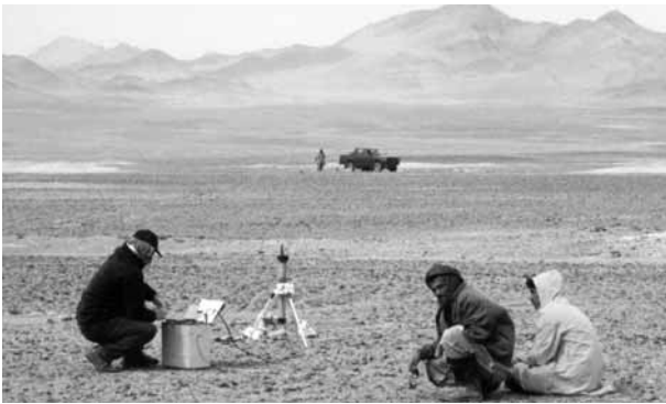
Photo 3. Prospection électromagnétique au sol au Beloutchistan pour l'exploration de porphyres cuprifères (cliché Noël White).
