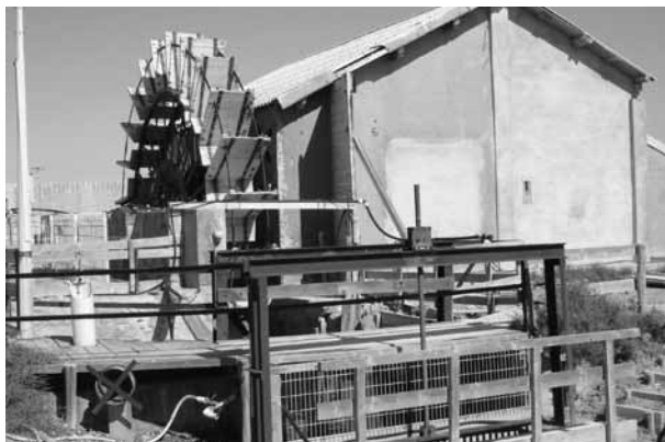
Photo 4. Salin de Giraud : roue à aubes utilisée pour le transfert des eaux (cliché Gérard Sustrac).
