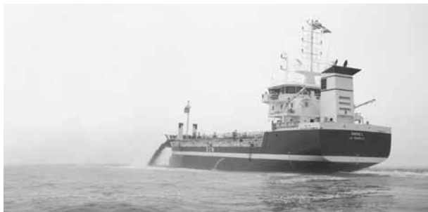
Photo 1. Le demi-cargo sablier André L, dont la capacité du puits est de 500 m 3 (cliché GSM).
