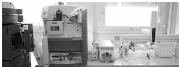
Photo 5. Chromatographie en phase liquide couplée à la spectrométrie de masse en mode tandem avec extraction en ligne (UPLC/MS/MS Quattro Waters™).
